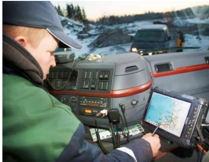
Mobiilijärjestelmällä voidaan kerätä yhteen muun muassa auton tankkaustiedot, työaikaseuranta, kuljetetut tonnit ja ajatut kilometrit.
